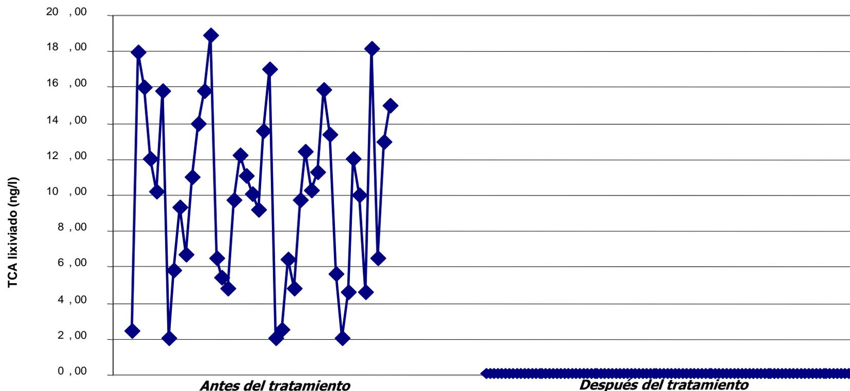
A escala industrial, los resultados de TCA lixiviado residual se sitúan todos por debajo el límite de la cuantificación del método analítico ( $\leq 0,3$  ng/l)
