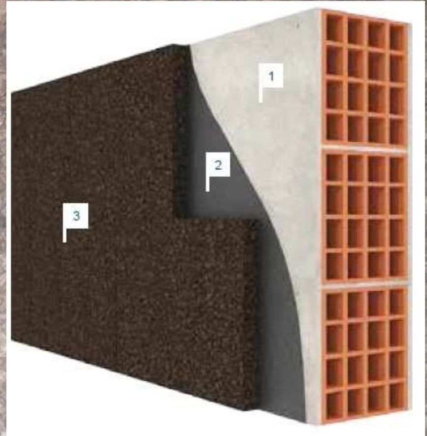
Revestimiento de fachadas exteriores con corcho visible
