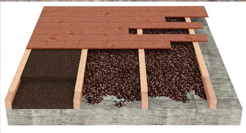
Relleno de pavimentos
