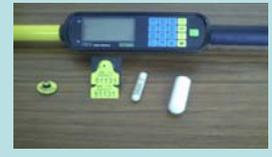
FOTO 1: Lector RFID de mano modelo comercial de AZASA. De izquierda a derecha: sistema HDX bolo ruminal, sistema FDX-bolo ruminal.
