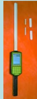
FOTO 2: Prototipo de lector RFID de mano con pantalla táctil desarrollado en el proyecto.
