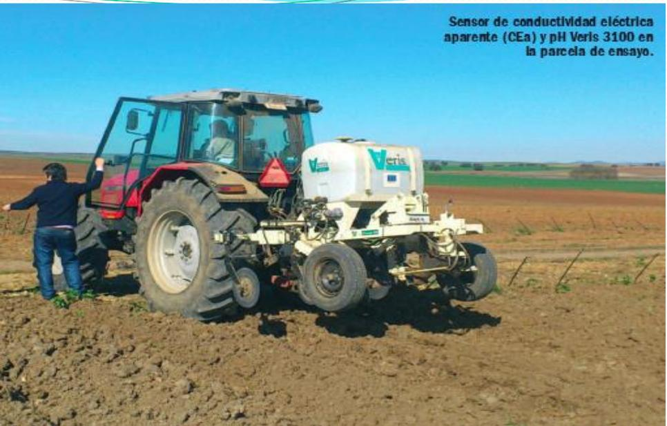
Sensor de conductividad eléctrica aparente (CEa) y pH Veris 3100 en la parcela de ensayo.
