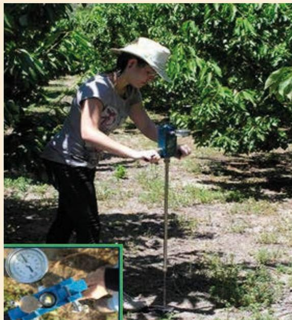
**Imagen 7.-** Utilización de la cámara de presión en campo.
