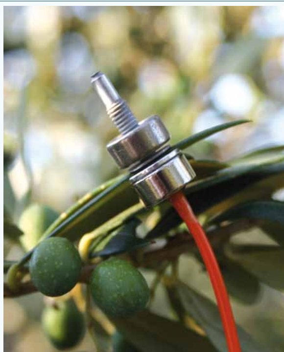
Foto 2. Sonda ZIM ( www.zim-plant-technology.com ) instalada en una hoja de olivo para la medida de su potencial de turgencia.
