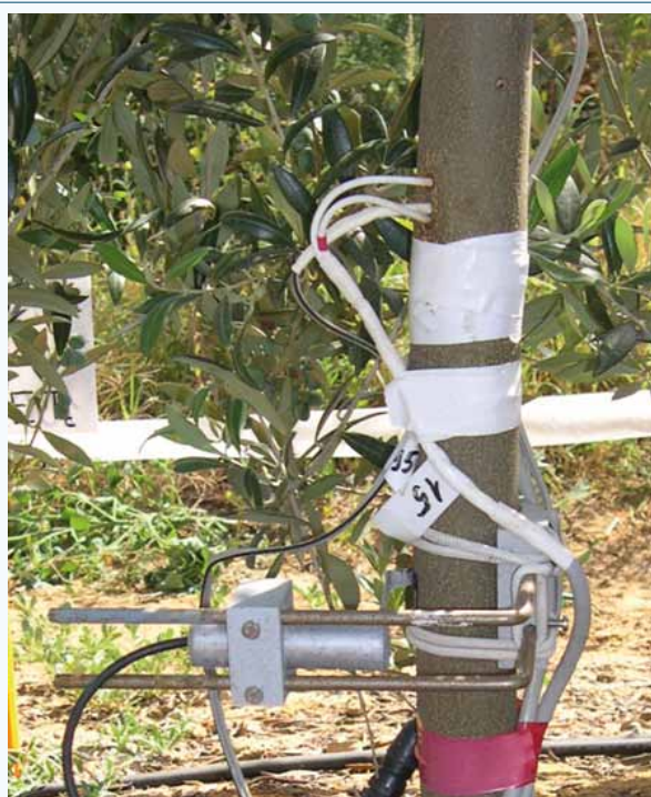
Foto 1. Sensores para la medida del flujo de savia y de las variaciones en el diámetro del tronco, instalados en un olivo 'Arbequina' de 4 años de edad.
