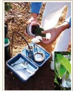
Foto 2. Cámara de presión y detalle de una hoja embolsada preparada para la determinación del  $\Psi_{\text{tallo}}$ .
