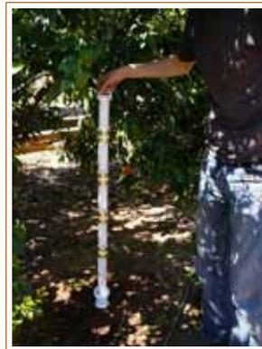
Foto 1. Sonda capacitiva con cuatro sensores de medida a distintas profundidades.
