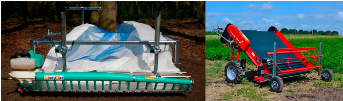
Figura 11. Equipos de mano para la recolección de plantas aromáticas y medicinales manejados por 2-3 operarios de las marcas EazyCut y VegTerra.
