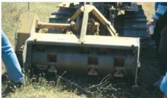
*Desbrozadora de eje horizontal o de martillos, accionada por un tractor de cadenas.*
