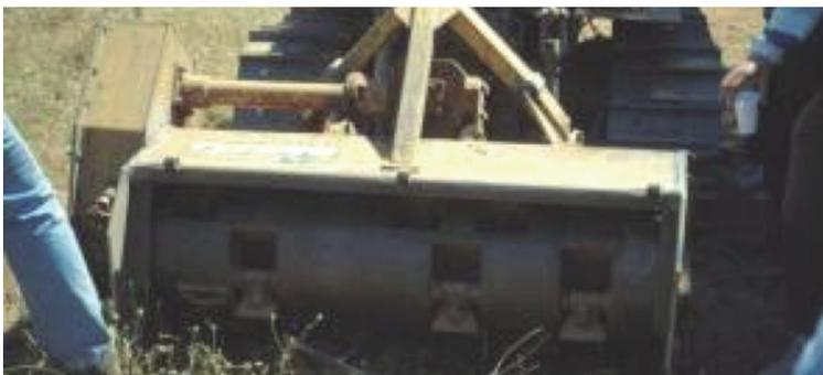
Moto-roçadora de eixo horizontal ou de martelos, acionada por um trator de lagartas.
