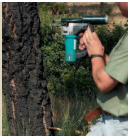
Descorche de un bornizo sollamado con máquina automática. Este equipo realiza los cortes con mucha precisión ya que está dotado de un sensor que regula la profundidad de penetración de la cuchilla.
