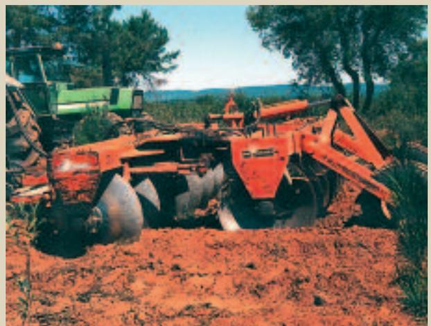
Grada de discos pesada montada en un tractor agrícola.
