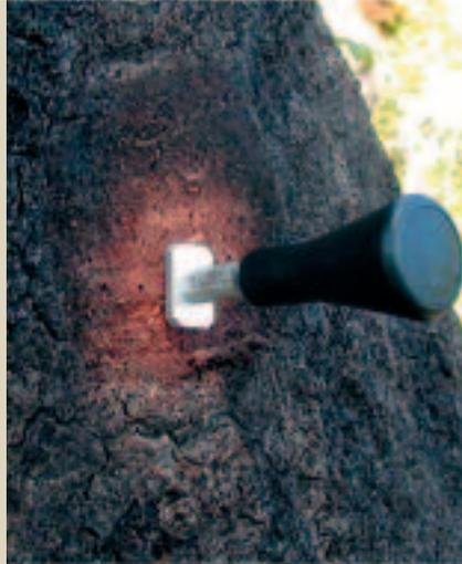
Calibrador de corteza midiendo el espesor de corcho por debajo de la zona carbonizada en un alcornoque en producción.
