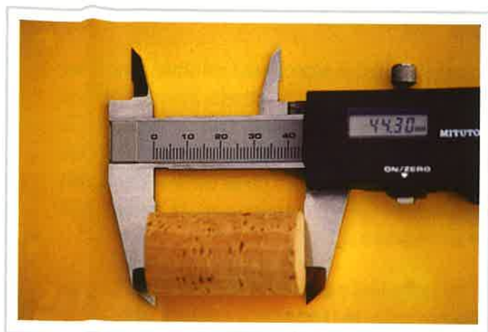
Figura 4.21: Pie de rey digital de 0.01 mm. de sensibilidad.
