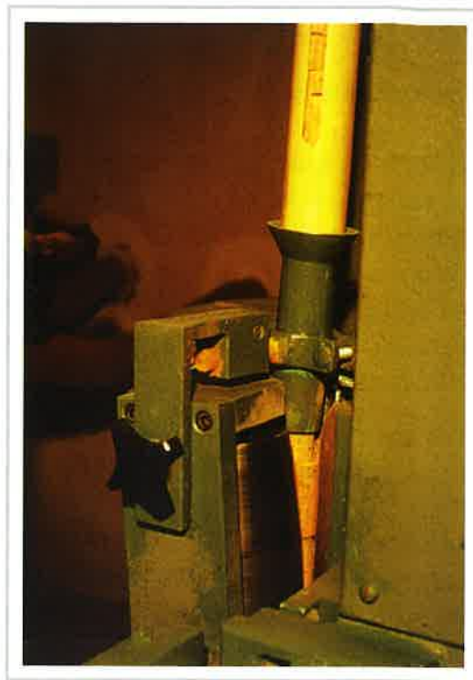
Figura 4.9: Lijadora de costados (detalle).
