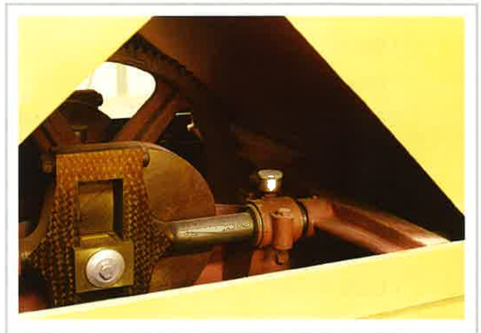
Figura 3.18: Detalle del sistema mecánico de empuje de pistones de la extrusora.
