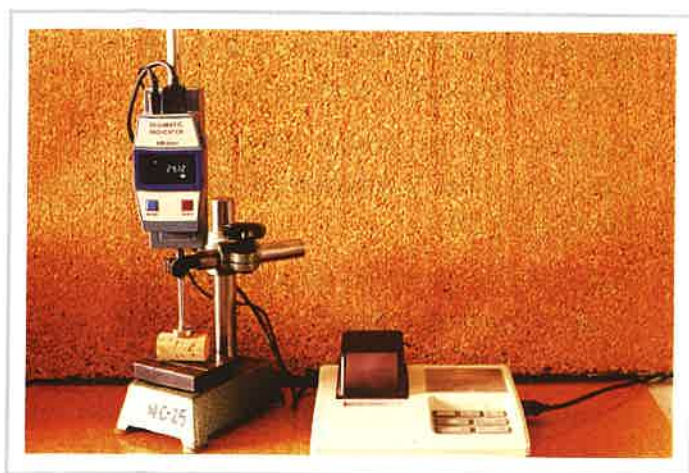
Figura 4.22: Comparador digital de 0.01 mm. de sensibilidad e impresora.
