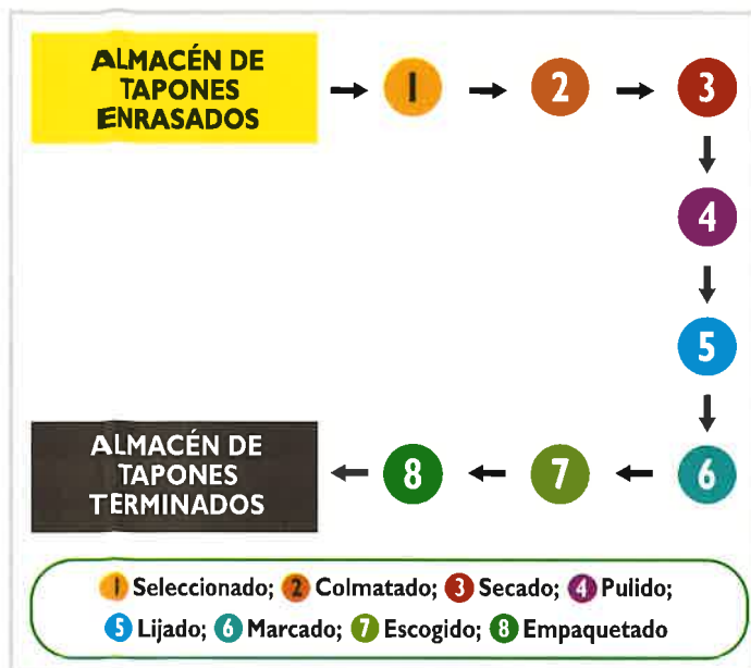
Figura 4.1: Esquema general de la terminación del tapón de corcho natural para vinos tranquilos.
