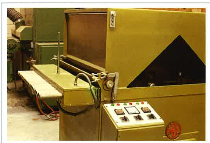
Figura 3.17: Detalle de tolva, controles, sistema aporte de calor y tubos de salida de la extrusora.
