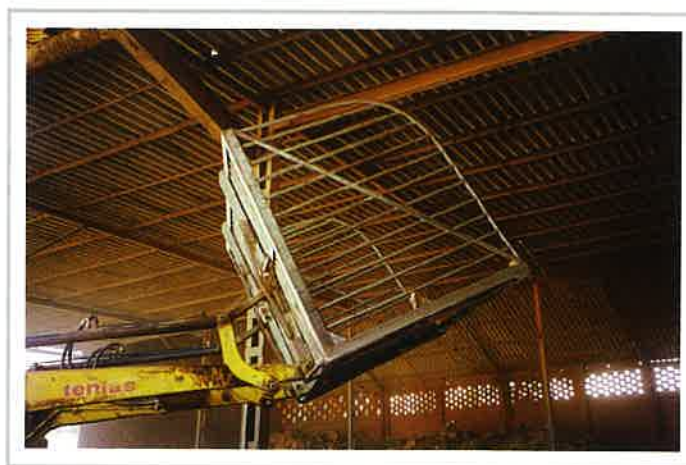
Figura 3.3: Pala para remontar el corcho y galpón al fondo.
