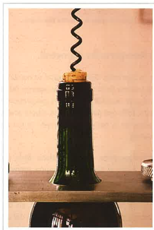
Figura 4.26: Fuerza de extracción. Sacacorchos normalizado.
