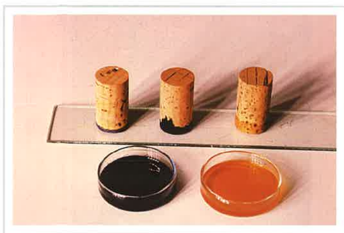
Figura 4.24: Capilaridad. Soluciones etanólicas con colorante azul de metileno y rojo.
