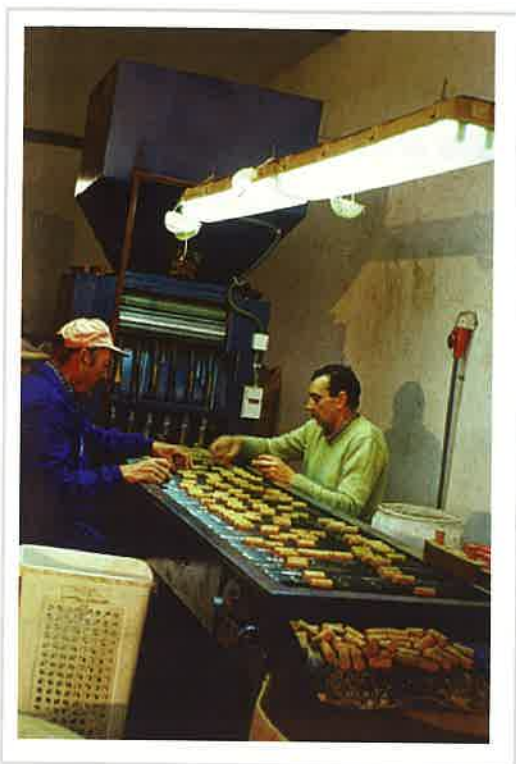
Figura 4.10: Cinta de escogido manual.
