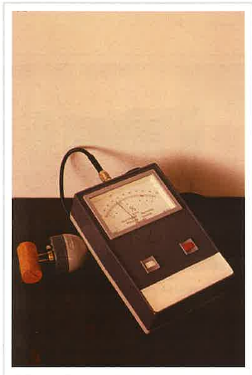
Figura 4.18: Equipo para la determinación rápida de la humedad.
