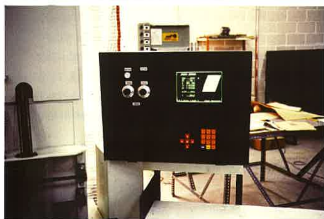
Figura 4.12: Clasificadora automática de tapones basada en tratamiento de imagen.
