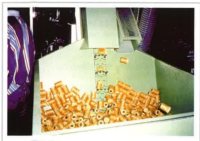
Figura 3.16: Tolva de alimentación, con tapones marcados para detección óptica.
