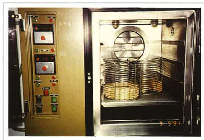
Figura 4.15: Cámara climática para estabilizar las muestras.
