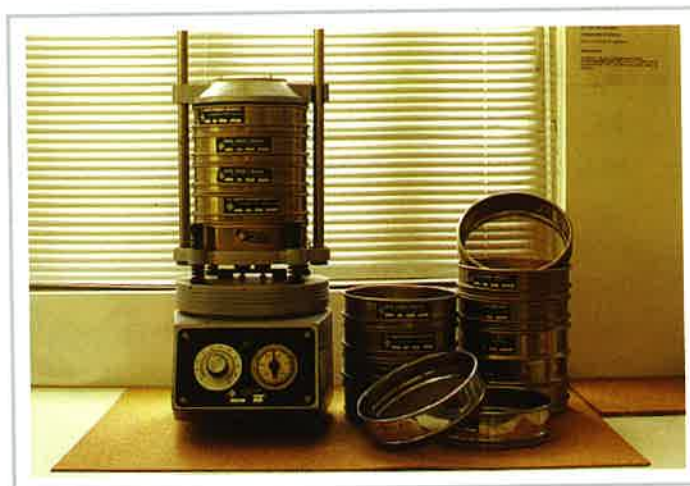
Figura 3.11: Máquina para hallar la granulometría.
