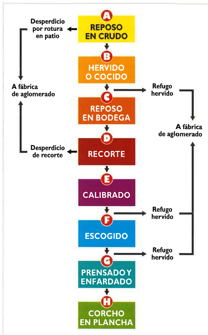
Esquema del proceso de preparación de corcho en plancha en una empresa preparadora.
