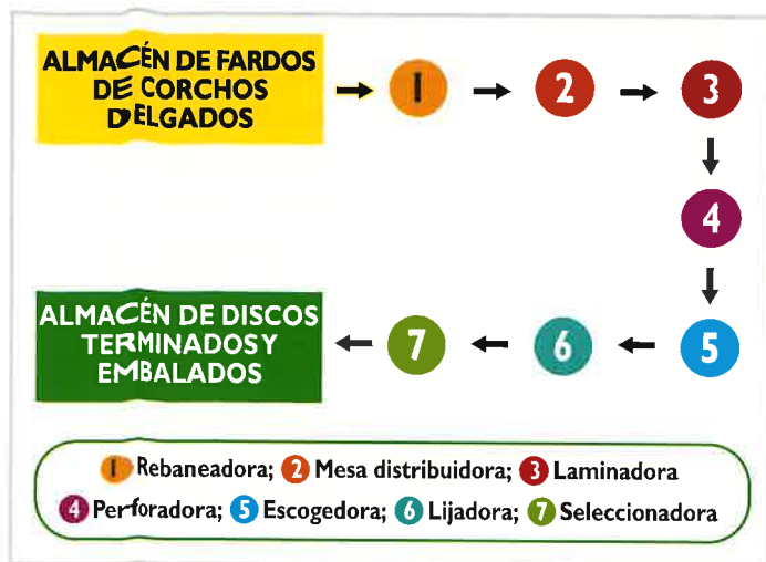
Figura 3.20: Esquema general de la fabricación de arandelas.
