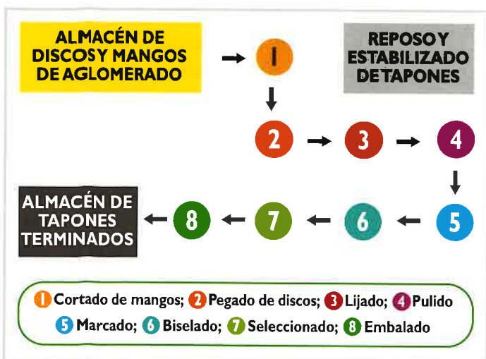
Figura 3.21: Esquema de la fabricación del tapón para vinos espumosos.
