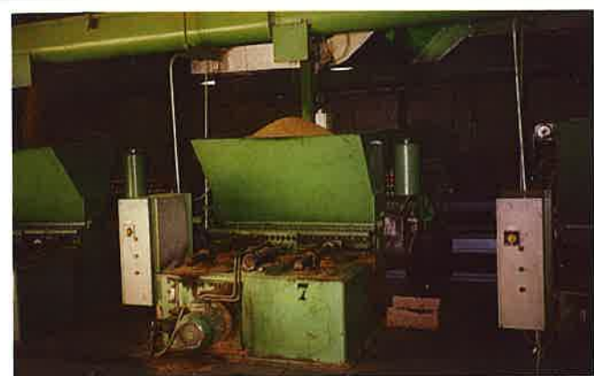
Figura 3.14: Vista general de extrusora donde se aprecia la tolva de alimentación y un sistema hidráulico de empuje.
