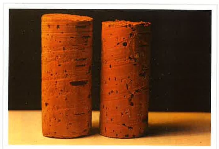
Figura 2.16: Tapones con costados arañados por gubia defectuosa.
