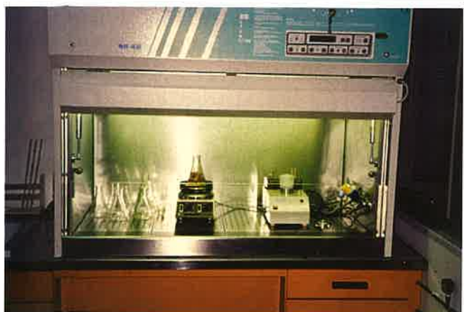
Figura 4.32: Campana de flujo laminar con material de ensayo microbiológico.
