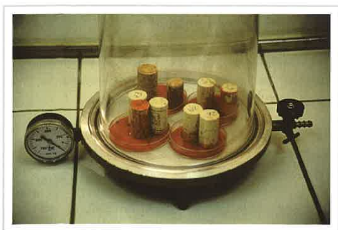
Figura 4.25: Capilaridad. Campana para evitar la evaporación de la solución etanólica.
