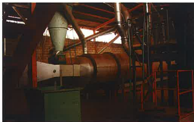
Figura 3.9: Secadero rotativo de serrines.
