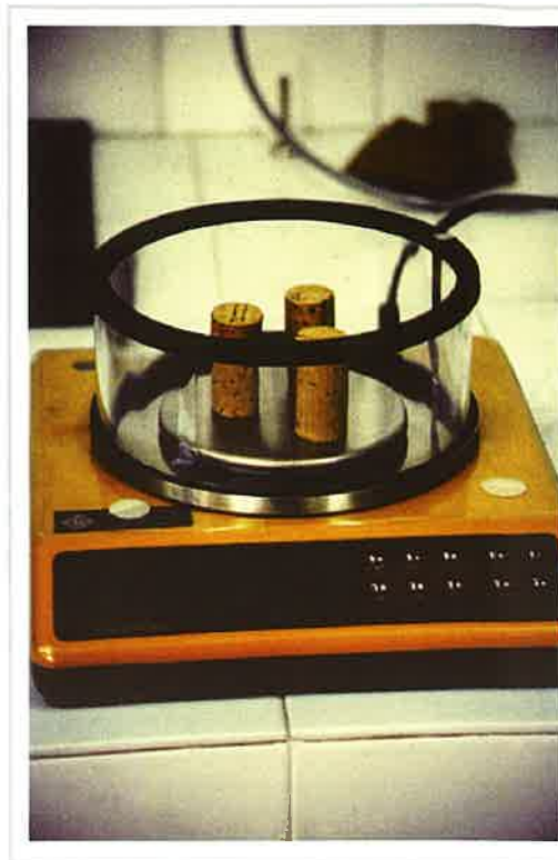
Figura 4.19: Balanza de 0.001 gr. de sensibilidad.
