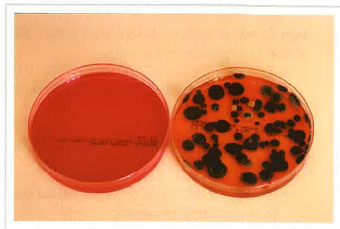
Figura 4.33: Cápsulas petri del ensayo en blanco y con tapones, de hongos filamentosos y levaduras.
