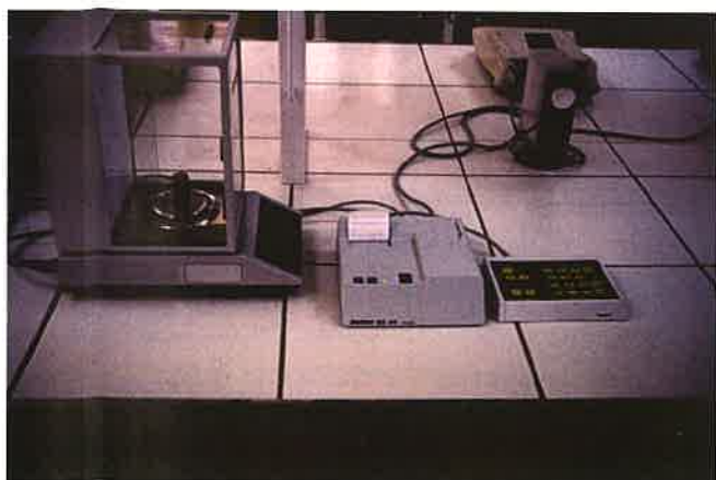
Figura 4.31: Balanza analítica de 0,0001 gr. de sensibilidad.
