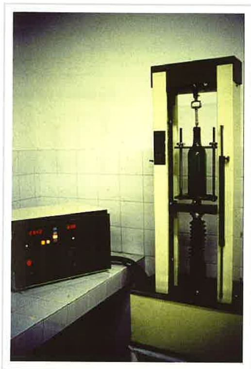
Figura 4.27: Fuerza de extracción. Dinamómetro.
