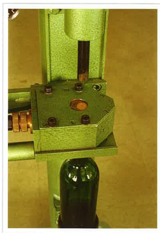
Figura 4.42: Detalle de encorchadora semiautomática de tres mordazas.
